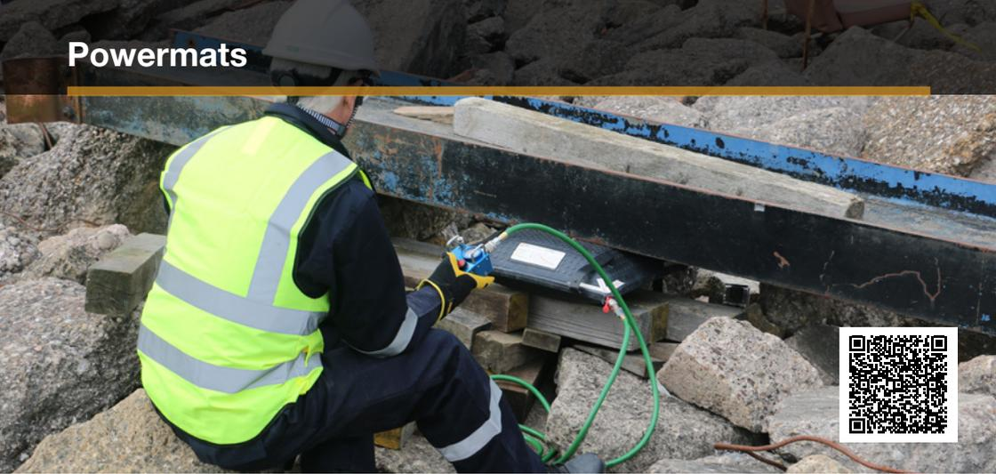
Powermat es una bolsa de elevación de alta presión para aplicaciones exigentes, diseñada especialmente para la elevación de vehículos y objetos en situaciones de emergencia. Desinflado, el Powermat tiene un perfil muy delgado, que permite utilizarlo en lugares restringidos o de difícil acceso, además de guardarlo fácilmente. Disponible en 12 tamaños estándar con capacidades de elevación máximas de 1 a 68 toneladas.
