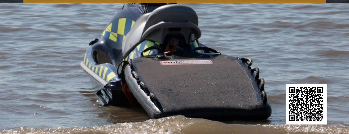
La tabla de rescate de moto acuática es una tabla inflable diseñada para fijarse en la parte posterior de una moto acuática y permitir una rápida respuesta y rescate de víctimas. Se sujeta mediante una argolla de remolque en 'D' y otras dos argollas en 'D' situadas en la parte frontal de la tabla inflable. La tabla dispone de 10 asas colocadas alrededor de la parte superior para permitir a las víctimas o al equipo de rescate subirse con más facilidad.
