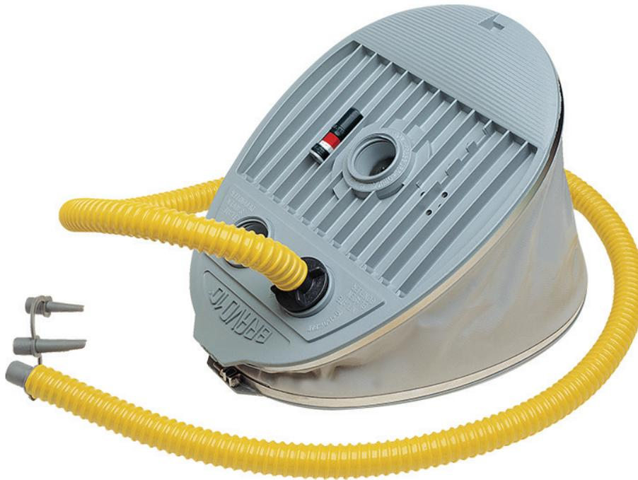
La bomba de pie Bravo 10 utiliza un diseño innovador para hacer que inflar y desinflar un tubo sea lo más sencillo posible. Tiene dos cámaras, una de 5 litros (alto volumen, baja presión) que se infla a 2,1 psi y una de 1,6 litros (bajo volumen, alta presión) que se infla a 4,4 psi.
