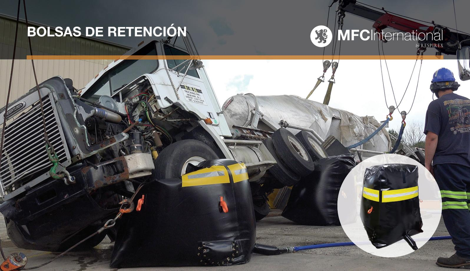
Las bolsas de retención de MFC International están diseñadas para usarse junto con nuestras bolsas de aire de alta elevación y baja presión durante el enderezado de vehículos o remolques.
