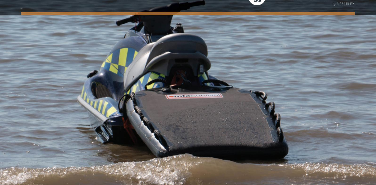
La tabla de rescate de moto acuática es una tabla inflable diseñada para fijarse en la parte posterior de una moto acuática y permitir una rápida respuesta y rescate de víctimas. Se fija mediante tres anillos en "D" de control y remolque ubicados en la parte delantera de la tabla inflable.
