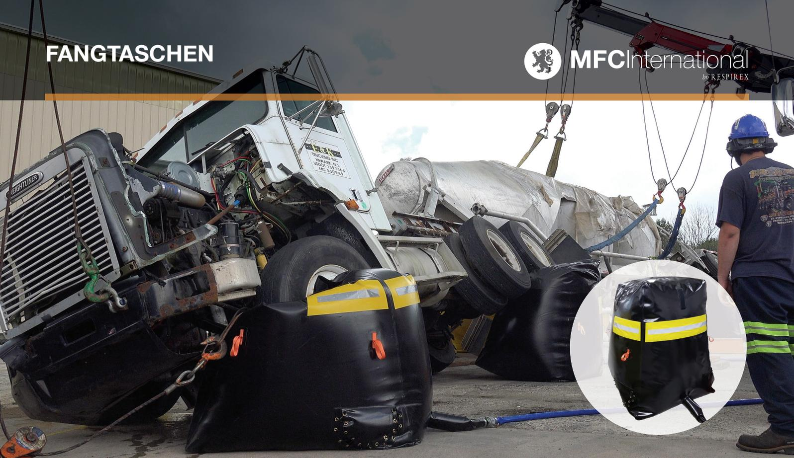
Die MFC International Fangtaschen sind für den Einsatz in Verbindung mit unseren Niederdruck-Hochhebesäcken beim Aufrichten von Fahrzeugen oder Anhängern konzipiert.
