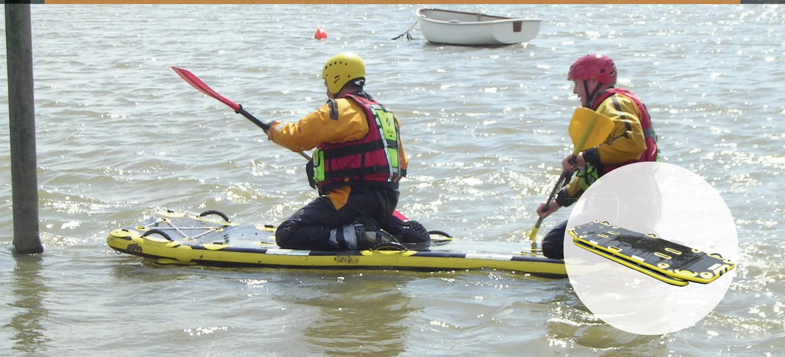
Le RP3 est une plateforme gonflable pour la récupération de victimes, principalement en eaux peu profondes, dans la boue, la glace et les milieux marécageux. Le RP3 constitue une plateforme de sauvetage très stable, grâce à ses boudins de style catamaran. Au besoin, la plateforme peut être tractée derrière un jet ski ou un canot de sauvetage rapide, et peut également se déplacer facilement à la rame ou à l'aide d'un câble.
