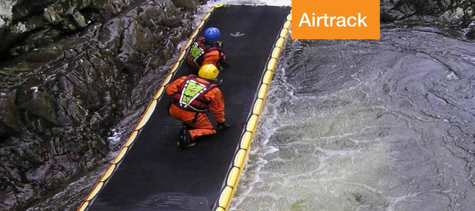
**L'Airtrack est un moyen de sauvetage gonflable pour accéder aux victimes lors d'un sauvetage dans la boue, la glace et en terrain instable, ainsi que pour le sauvetage aquatique.**
